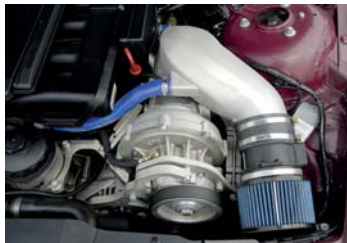
Preiswerte Power: Günstiger als mit diesem Lader sind 74 Zusatz-PS legal nicht zu bekommen
