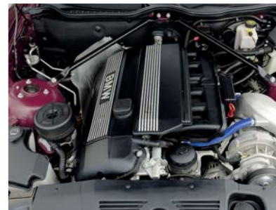
Nachgeladen: Abgesehen von der Turbo-Aufladung bleibt der Motor bei diesem Tuning unangetastet
